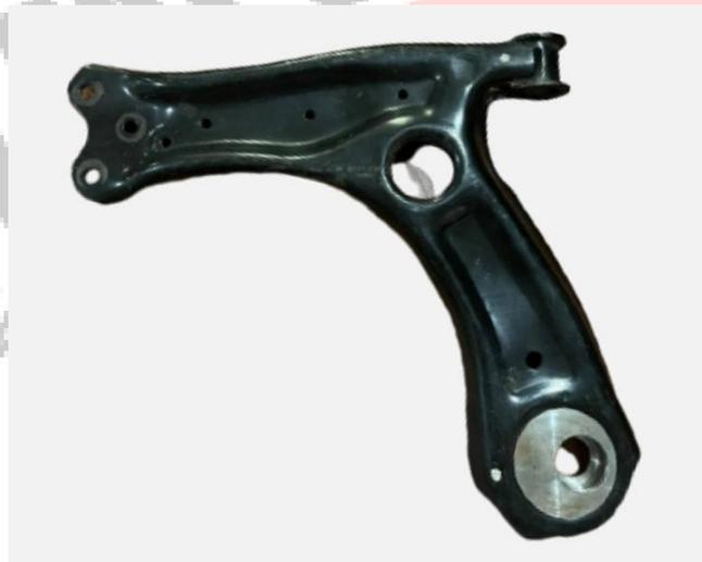
**FORD KA:** Para la parrilla se autoriza a cambiar el buje silentblock de la parte trasera de la parrilla, por una rótula cilíndrica dentro del alojamiento original, dicha rótula se podrá adaptar a través de una camisa metálica en forma concéntrica a la pieza original.
