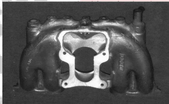
**15.11. BRIDA RESTRICTORA:** Se deberá instalar entre el carburador y la base del múltiple una brida restrictora de material metálico, de un espesor de 4mm  $\pm$ 0,5mm; con un saliente que tenga un orificio de 2mm para su precintado, para todas las marcas y cilindradas. En el caso de tener que utilizarse en los modelos a inyección, la comisión técnica de la FAPCDMS
